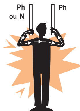
FIG. 3 : Risque par contact direct phase-neutre . Ce risque ne peut être prévenu par l'utilisation d'un dispositif différentiel.
